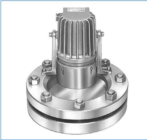
VETROLUX-Leuchtschauglas, bestehend aus Schauglasarmatur nach DIN 28120, DN 150, PN 10, mit aufgebauter CHEMLUX-Leuchte, Typ KEL 20 deH Sch B, 230 V, 20 W, Ex d e IIC T4 Gb, Ex t IIIC T130°C Db IP67, Ex II 2 G + D, mit Blendschutz «B» als Anordnung «Licht- und Sichtglas»
