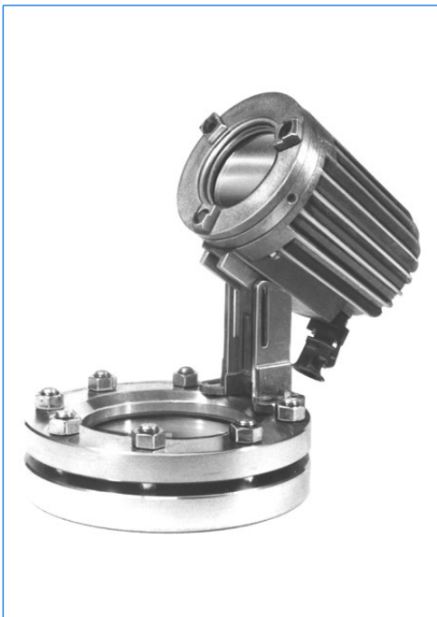
Runde Schauglasarmatur nach DIN 28120, DN 125, PN 10, mit thermisch vorgespannter Natronkalkglasscheibe nach DIN 8902 (Presshartglas), bestückt mit CHEMLUX-Leuchte Typ L 20 deHSch.
