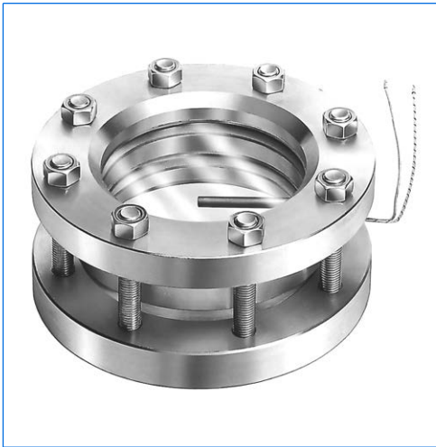
Schauglasarmatur ähnlich DIN 28120, DN 150, PN 16, mit Doppelverglasung und integriertem Heizelement, 24 V, 50 W
