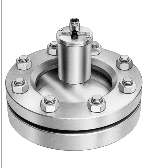
Schauglasleuchte Typ KVLR 20 HDW, 20 W, 24 V, mit eingebautem Drucktaster «D», auf runder Schauglasarmatur nach DIN 28120, DN 100, PN 10, in Anordnung «Sicht und Licht durch eine Armatur».
