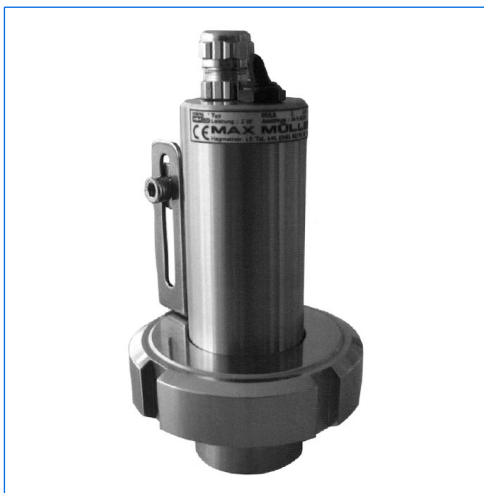
Micro-LED-Schaugglasleuchte, Typ MVLR 2 LED E Sch1, 2 W, 24 V AC/DC, mit eingebautem «Ein-Aus»-Schalter «E», auf VETROLUX Schraub-Schauglasarmatur ähnlich DIN 11851, DN 32, PN 6
