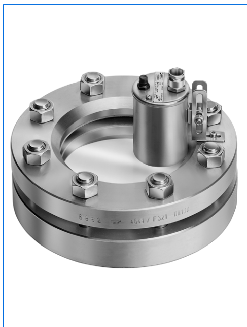
Schauglasleuchte Typ BKVLR 20 HDSch, 20 W, 24 V, mit eingebautem Drucktaster «D», auf runder Schauglasarmatur nach DIN 28120, DN 100, PN 10, in Anordnung «Sicht und Licht durch eine Armatur».
