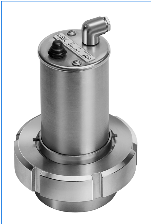
Schauglasleuchte Typ KLR 100 HD R80 K2, 100 W, 24 V, mit eingebautem Drucktaster, auf Schraub-Schauglasarmatur ähnlich DIN 11851, DN 80, PN 6.
