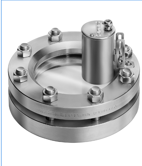
Schauglasleuchte Typ KLR PowerLED Sch, 7 W, 230–240 V, auf runder Schauglasarmatur nach DIN 28120, DN 150, PN 10, in Anordnung «Sicht und Licht durch eine Armatur».
