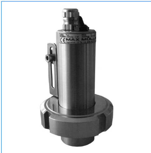
Micro-LED-Schauglasleuchte, Typ MVLR 2 LED E Sch1, 2 W, 24 V AC/DC, mit eingebautem «Ein-Aus»-Schalter «E», auf VETROLUX Schraub-Schauglasarmatur ähnlich DIN 11851, DN 32, PN 6
