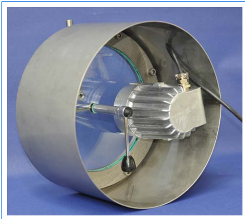
Hublot VETROLUX® similaire à DIN 28120, DN 200, PN 0, soudé sur tuyau à sceller dans la paroi d'un fermenteur, avec essuie-glace central, lave-vitre et projecteur adf CHEMLUX®, type FKEL 50 dH, 50 W, 24 V, Ex d IIC T3 Gb, Ex II 2 G + D, fixation du projecteur par articulation sphérique
