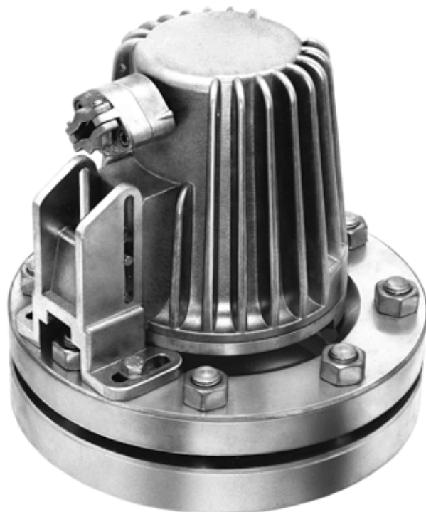
Type F 20 dH SchU, Ex d IIC T5 Gb, Ex t IIIC T95°C Db IP67, Ex II 2 G + D, ampoule halogène, 230 V, 20 W, temporisation «U» incorporée, sur hublot selon DIN 28120, DN 125, PN 10, fixation par charnière «Sch».
