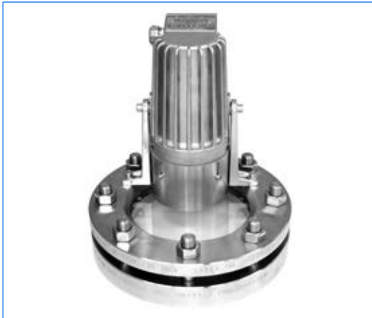
Type HEL 35 deHSchB, Ex d e op is IIC T4 Gb, Ex t IIIC T130°C Db IP67, Ex II 2 G + D, 230 V, 35 W, version halogène, avec pare-reflets «B», monté sur hublot selon DIN 28120, DN 150, PN 6, en version «vue et éclairage par un seul hublot».
