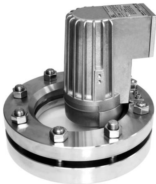
Type HEL 50 deHW, Ex d e op is IIC T3 Gb, Ex t IIIC T195°C Db IP67, Ex II 2 G + D, 230 V, 50 W, version halogène, monté sur un hublot selon DIN 28120, DN 125, PN 10. Montage en version «vue et éclairage par un seul hublot».
