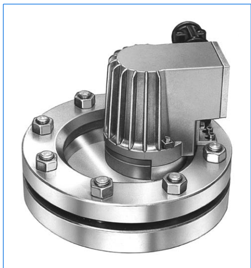
Type adf KEL de PowerLED W, Ex de op is IIC T6 Gb, Ex tb IIIC T80°C Db, IP65/67, Ex II 2 G + D, 230-240 V AC, 7 W, monté sur un hublot selon DIN 28120, DN 125, PN 10. Montage en version «vue et éclairage par un seul hublot».
