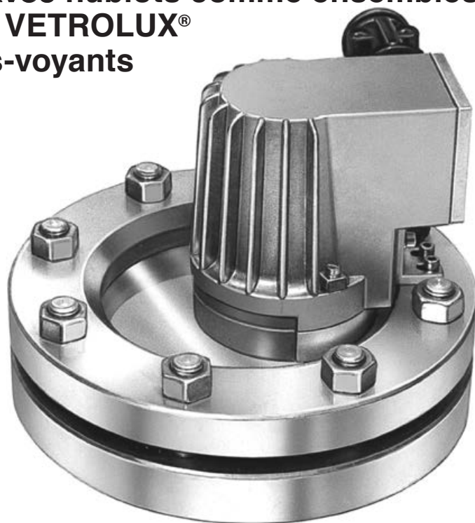
Type KEL 20 deH W, Ex d e IIC T4 Gb, Ex t IIIC T130°C Db IP67, Ex II 2 G + D, 230 V, 20 W, monté sur un hublot selon DIN 28120, DN 125, PN 10. Montage en version «vue et éclairage par un seul hublot».
