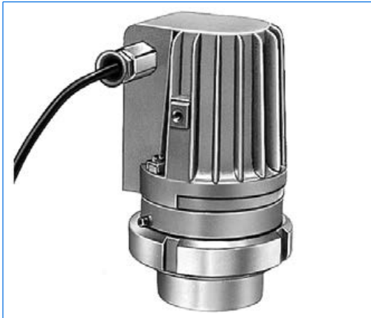
Type FKEL 20 dH R, Ex d IIC T4 Gb, Ex t IIIC T130°C Db IP67, Ex II 2 G + D, 230 V, 20 W, montage par disque à col étiré sur hublot vissé similaire à DIN 11851, DN 65, PN 6.
