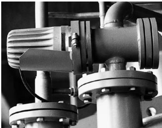
Projecteur CHEMLUX®, type L 20 deH M sp, 20 W, 24 V, Ex d e IIC T5 Gb, Ex t IIIC T95°C Db IP67, Ex II 2 G + D, avec verre opalisé «M», monté sur un contrôleur visuel de circulation
