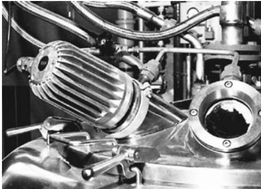
Projecteur CHEMLUX®, type L 20 deH Sch, 20 W, 230 V, Ex de IIC T5 Gb, Ex t IIIC T95°C Db IP67, Ex II 2 G + D, avec fixation par charnière «Sch», monté sur une centrifugeuse
