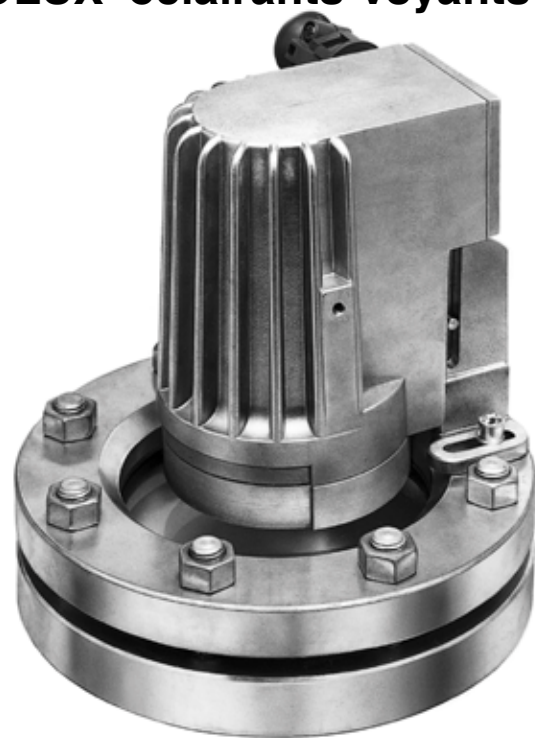
Type PEL 50 deHSch, Ex d e IIC T4 Gb, Ex t IIIC T130°C Db IP67, Ex II 2 G + D, 230 V, 50 W, monté sur un hublot selon DIN 28120, DN 125, PN 10. Montage en version «éclairage».
