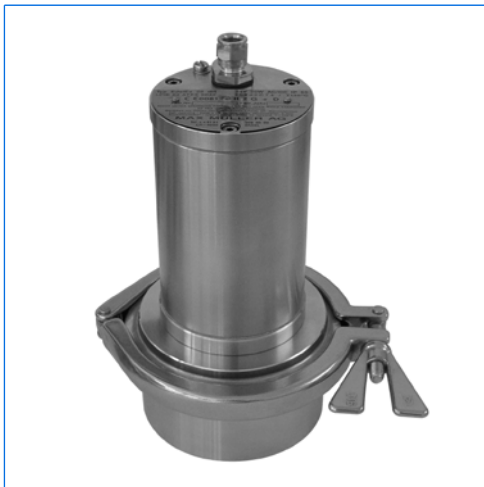
Projecteur LED EdelLUX, type EdelEx LED, Ex d IIC T6 Gb, Ex t IIIC T80°C Db IP67, Ex II G + D, monté sur hublot à verre moulé pour raccords Triclamp®, DN 50, PN 16
