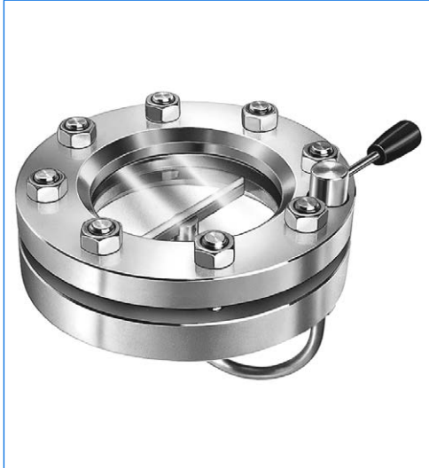
Essuie-glace, système WS, monté dans un hublot VETROLUX® selon DIN 28120, PN 10, DN 100.
