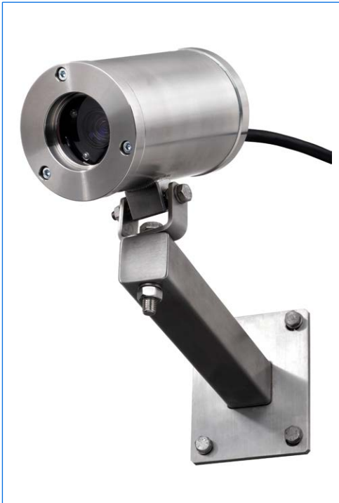
Caméra adf Vario, enveloppe en acier INOX, Ex d IIB T6, Ex tD A21 IP67 T80°C, Ex II 2 G + D, avec fixation murale.
