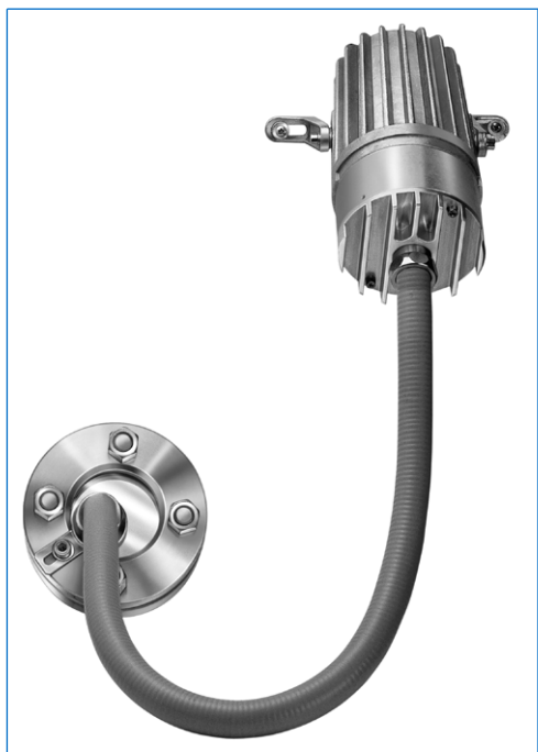
Projecteur adf à fibre optique avec temporisation «V», type fibroLUX® 5035 X1 W2 V, Ex d e IIC T4 Gb, Ex t IIIC T130°C Db IP67, Ex II 2 G + D, 35 W, 230 V, fixation de la source lumineuse par pieds «X1», fixation de la fibre optique avec collier «W2» sur hublot selon DIN 28120, DN 40, PN 10
