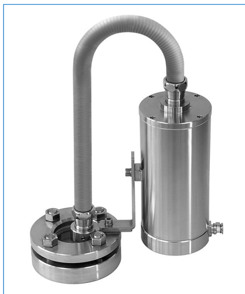
Projecteur adf à fibre optique entièrement en acier INOX, type fibroLUX E 5035 W2 sp, Ex d IIC T4 Gb, Ex t IIIC T130°C Db IP67, Ex II 2 G + D, 35 W, 24 V AC, fixation de la source lumineuse avec équerre «W», fixation de la fibre optique par collier «W2» sur hublot selon DIN 28120, DN 40, PN 10
