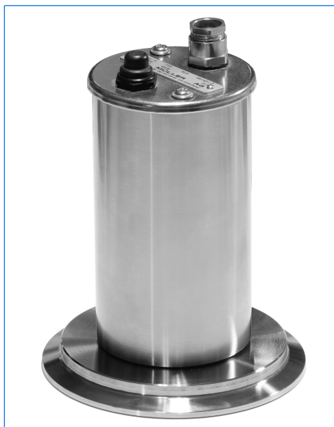
Projecteur type KLR 20 HDAsp, 20 W, 115 V, avec bouton-poussoir «D», monté sur hublot à verre moulé pour des raccords Tri-Clamp, DN 100
