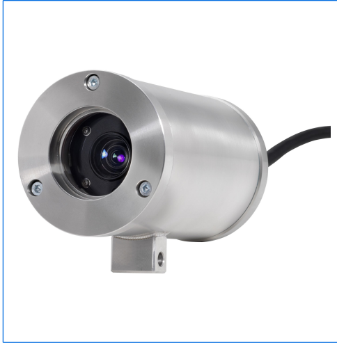
Caméra adf miniZoom, enveloppe en acier INOX, Ex d IIB T6, Ex tD A21 IP67 T80°C, Ex II 2 G + D.
