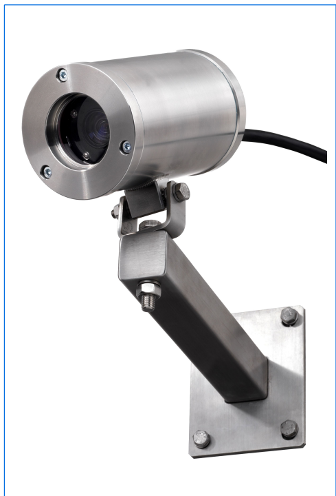
Caméra adf niteZoom, enveloppe en acier INOX, Ex d IIB T6, Ex tD A21 IP67 T80°C, Ex II 2 G + D, avec fixation murale.
