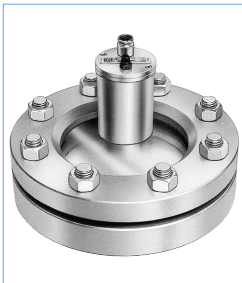
Projecteur type KVLR 20 HDW, 20 W, 24 V, avec bouton-poussoir «D», monté sur hublot selon DIN 28120, DN 100, PN 10, en version «vue et éclairage par un seul hublot».
