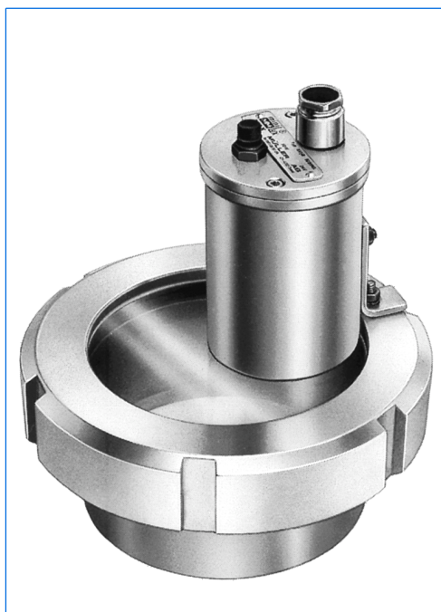
Projecteur type KVLR 50 HDW1, 50 W, 24 V, avec bouton-poussoir «D», monté sur hublot vissé similaire à DIN 11851, DN 100, PN 6, en version «vue et éclairage par un seul hublot».
