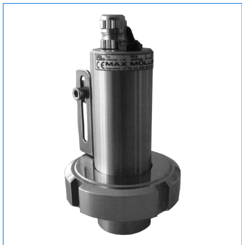
Micro-projecteur LED, type MVLR 2 LED E Sch1, 2 W, 24 V AC/DC, avec interrupteur «marche-arrêt» «E» incorporé, monté sur hublot vissé VETROLUX similaire à DIN 11851, DN 32, PN 6
