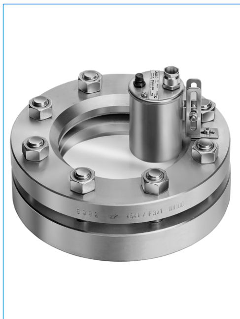
Projecteur type BKVLR LED DSch, 24 V, avec bouton-poussoir «D», monté sur hublot selon DIN 28120, DN 100, PN 10, en version «vue et éclairage par un seul hublot».
