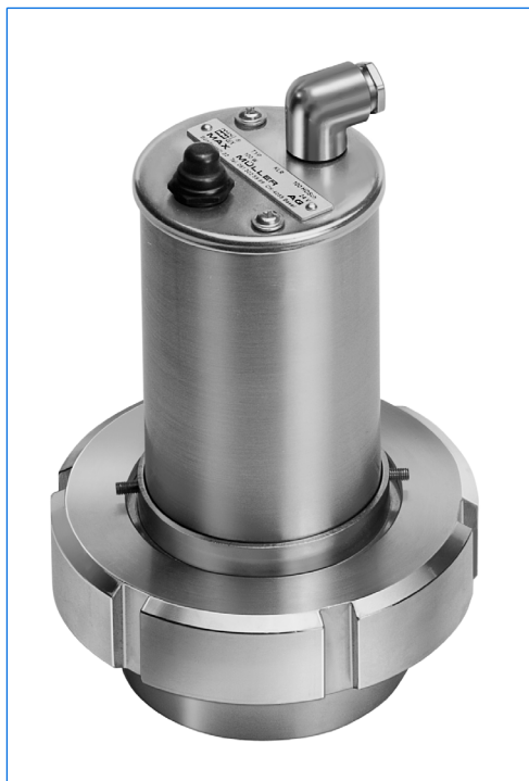
Projecteur type KLR 100 HD R80 K2, 100 W, 24 V, avec bouton-poussoir «D», monté avec disque à col étiré «R80» sur hublot vissé similaire à DIN 11851, DN 80, PN 6.
