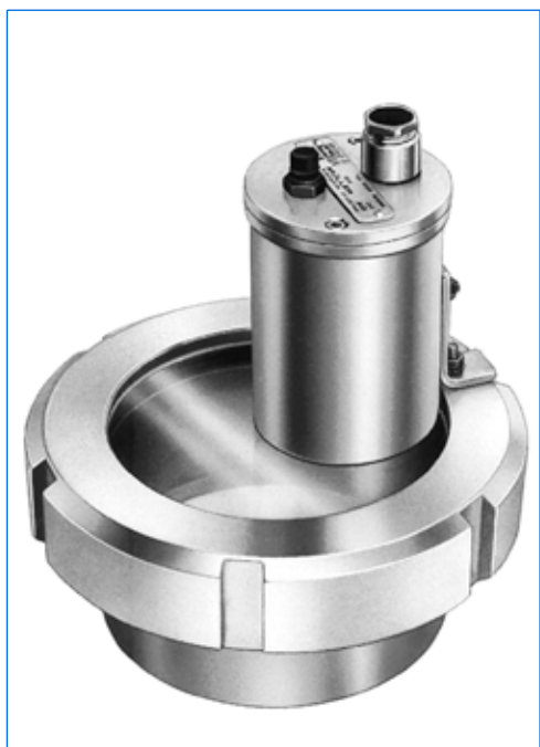
Projecteur type KVLR 50 HDW1, 50 W, 24 V, avec bouton-poussoir «D», monté sur hublot vissé similaire à DIN 11851, DN 100, PN 6, en version «vue et éclairage par un seul hublot».
