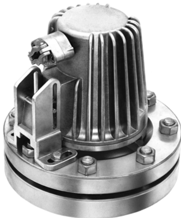
Proiettore tipo F 20 dH Sch U, Ex d IIC T5 Gb, Ex t IIIC T95°C Db IP67, Ex II 2 G + D, lampadina alogena, 230 V, 20 W, temporizzatore «U» incorporato, montato su oblò secondo DIN 28120, DN 125, PN 10
