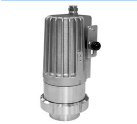
Tipo FHEL 35 dHVRK1, Ex d op is IIC T4 Gb, Ex t I IIC T130°C Db IP67, Ex II 2 G + D, 230 V, 35 W, versione alogena, con temporizzatore «V», montato con cartella «R» su oblò avvitato similare a DIN 11851, DN 65, PN 6.
