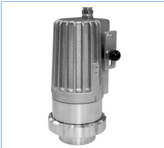
Tipo FHEL 35 dHVRK1, Ex d IIC T4 Gb, Ex t IIIC T130°C Db / IP67, Ex II 2 G + D, 230 V, 35 W, versione alogena, con temporizzatore «V», montato con cartella «R» su oblò avvitato similare a DIN 11851, DN 65, PN 6.
