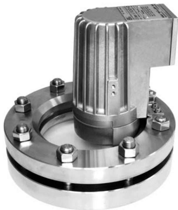
TipoHEL 50deHW, ExdeopisIICT3Gb, ExtIIICT195°CDBIP67, ExII2G+D, 230 V, 50 W, versione alogena, su oblò secondo DIN 28120, DN 125, PN 10. Montaggio in versione «vista ed illuminazione attraverso un oblò unico»
