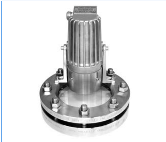
Tipo HEL 35 deHSchB, Ex d e IIC T4 Gb, Ex t IIIC T130°C Db / IP67, Ex II 2 G + D, 230V, 35W, versione alogena, con antiscermo «B», montato su oblò secondo DIN 28120, DN 150, PN 6, in versione «vista ed illuminazione attraverso un oblò unico».
