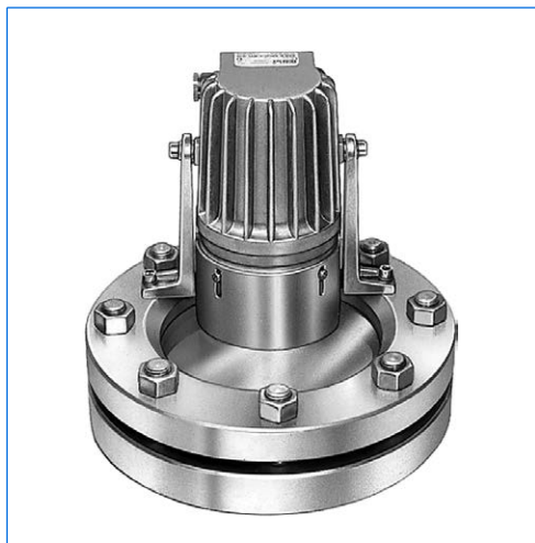
Tipo non AD-PE KL PowerLED Sch B, 24 V AC / DC, 7 W, con antiscermo «B», montato su oblò secondo DIN 28120, DN 150, PN 10, in versione «vista ed illuminazione attraverso un oblò unico».
