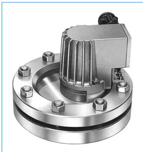
Tipo AD-PE KEL de PowerLED W, Ex de op is IIC T6 Gb, Ex tb IIIC T80°C Db, Ex II 2 G + D, IP65/67, 230–240 V AC, 7 W, su oblò secondo DIN 28120, DN 125, PN 10. Montaggio in versione «vista ed illuminazione attraverso un oblò unico».
