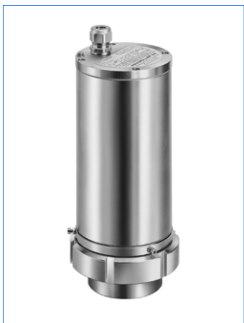
Proiettore tipo EdelEx G20 dH R80 K1, 20 W, 230 V, Ex d IIC T5 Gb, Ex t IIIC T95°C Db IP67, Ex II 2 G + D, con cartella di fissaggio «R80» su oblò avvitato similare a DIN 11851, PN6, DN 80.
