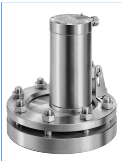
Proiettore tipo EdelEx 50 dH Sch K2, 50 W, 230 V, Ex d IIC T4 Gb, Ex t IIIC T130°C Db IP67, Ex II 2 G + D, con staffa di fissaggio «Sch» su oblò rotondo secondo DIN 28120, PN 10, DN 150
