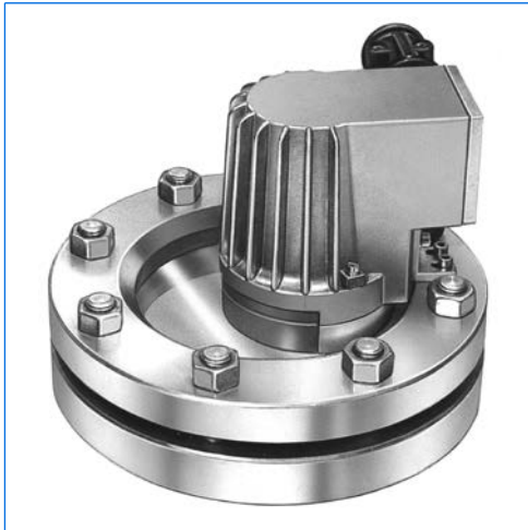
Proiettore LED CHEMLUX, tipo KEL de PowerLED-F W, Ex d e op is IIC T6 Gb, Ex t IIIC T80°C Db IP65/67, Ex II G + D, montato su oblò secondo DIN 28120, DN 125, PN 10
