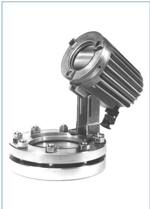
Oblò rotondo secondo DIN 28 120, DN 125, PN 10, vetro in calciosodico secondo DIN 8902, con proiettore CHEMLUX, tipo L 20 deH Sch, fissaggio con staffa incernierata
