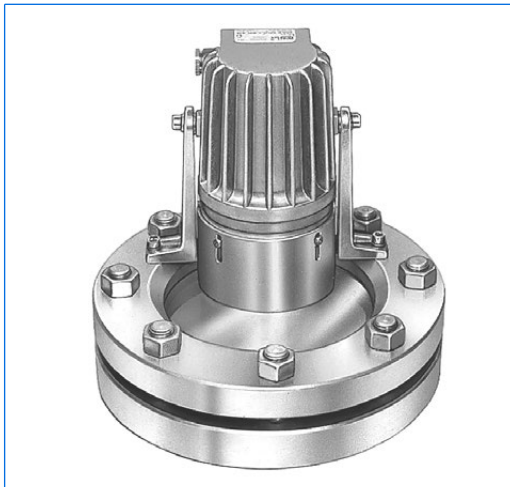
Gruppo completo illuminante-vedente VETROLUX componendosi di un oblò secondo DIN 28120, DN 150, PN 10, con proiettore CHEMLUX tipo KEL 20 deH Sch B, 230 V, 20 W, Ex d e IIC T4 Gb, Ex t IIIC T130°C Db IP67, Ex II 2G+D, con antiscermo «B» in versione «vista ed illuminazione attraverso un oblò unico»
