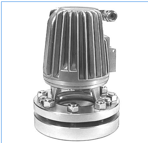
Gruppo completo illuminante-vedente VETROLUX componendosi di un oblò secondo DIN 28 120, DN 80, PN 10, con proiettore CHEMLUX tipo F 20 dHNsp, 24 V, 20W, Ex d IIC T5 Gb, Ex t IIIC T95°C Db IP 67, Ex II 2G+D
