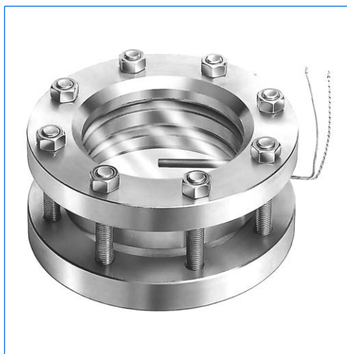
Oblò con doppio vetro simile a DIN 28120, DN 150, PN 16, con elemento riscaldante incorporato, 24 V, 50 W
