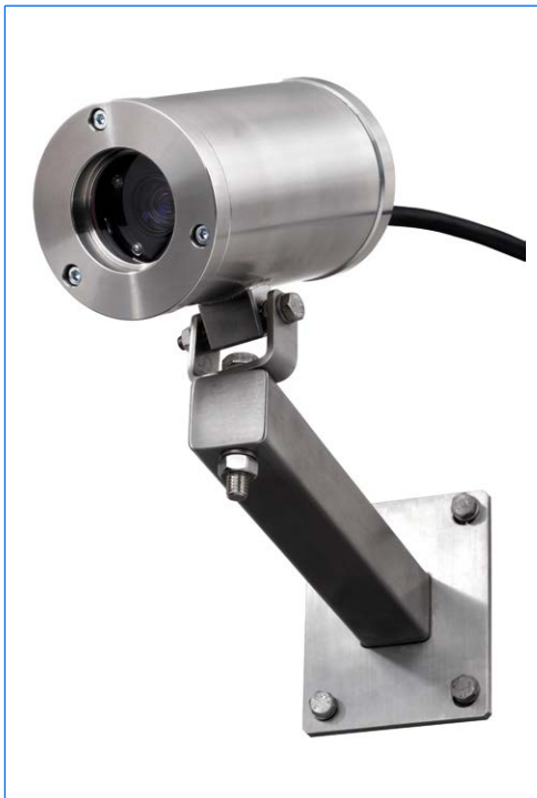
Videocamera AD-PE Vario, corpo in acciaio inossidabile, Ex d IIB T6, Ex tD A21 IP67 T80°C, Ex II 2 G + D, con fissaggio murale.
