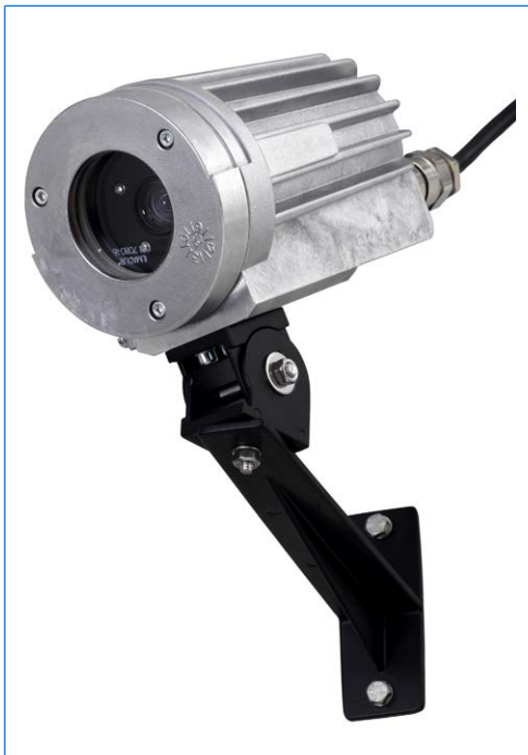
Videocamera AD-PE Vario, corpo in lega di alluminio, Ex d IIC T6, Ex tD A21 IP67 T80°C, Ex II 2 G + D, con fissaggio murale.
