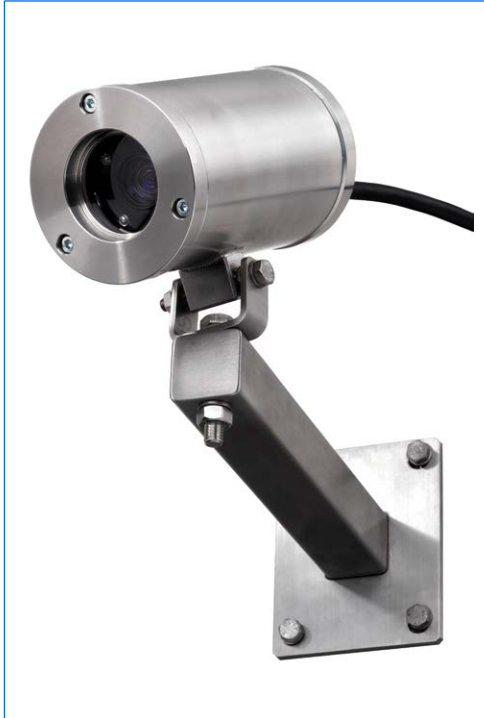
Videocamera AD-PE miniZoom, corpo in acciaio inossidabile, Ex d IIB T6, Ex tD A21 IP67 T80°C, Ex II 2 G + D, per fissaggio murale.
