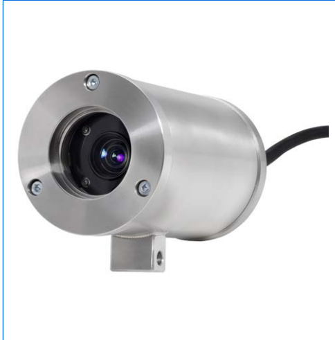
Videocamera AD-PE niteZoom, corpo in acciaio inossidabile, Ex d IIB T6, Ex tD A21 IP67 T80°C, Ex II 2 G + D.
