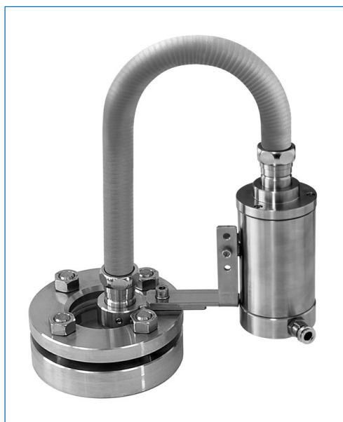
Proiettore AD-PE in acciaio inossidabile con fibra ottica, tipo fibroLUX E d PowerLED W W2 K2, Ex II 2 G + D, 7 W, 24 V AC / DC, fissaggio della sorgente luminosa con squadra «W», fissaggio della fibra ottica con anello «W2» su oblò secondo DIN 28120, DN 40, PN 10
