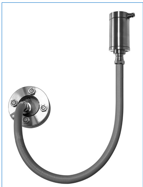
Proiettore AD-PE in acciaio inossidabile con fibra ottica, tipo fibroLUX E d PowerLED Sch W2 K2, Ex II 2 G + D, 7 W, 230-240 V AC, fissaggio della sorgente luminosa con staffa di fissaggio «Sch», fissaggio della fibra ottica con anello «W2» su oblò secondo DIN 28120, DN 40, PN 10
