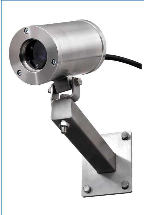
Videocamera AD-PE niteZoom, corpo in acciaio inossidabile, Ex d IIB T6, Ex tD A21 IP67 T80°C, Ex II 2 G + D, con fissaggio murale.
