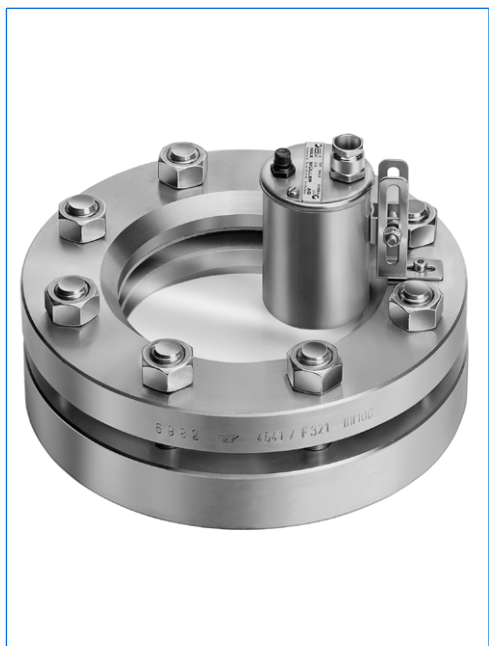
Proiettore tipo BKVLR LED DSch, 24 V, con pulsante incorporato «D», montato su oblò secondo DIN 28120, DN 100, PN 10, in versione «vista ed illuminazione attraverso un oblò unico».
