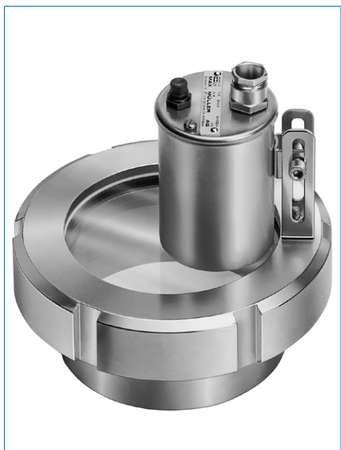
Proiettore tipo BKVLR LED DSch1, 24 V, con pulsante incorporato «D», montato su oblò avvitato simile a DIN 11851, DN 100, PN 6, in versione «vista ed illuminazione attraverso un oblò unico».
