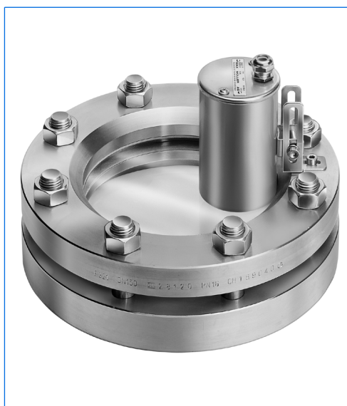
Proiettore tipo KLR PowerLED Sch, 7 W, 230-240 V, montato su oblò secondo DIN 28120, DN 150, PN 10, in versione «vista ed illuminazione attraverso un oblò unico».
