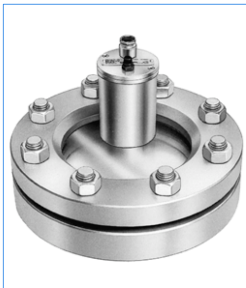
Proiettore tipo KVLR 20 HDW, 20 W, 24 V, con pulsante incorporato «D», montato su oblò secondo DIN 28120, DN 100, PN 10, in versione «vista ed illuminazione attraverso un oblò unico».
