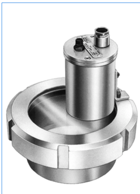
Proiettore tipo KVLR 50 HDW1, 50 W, 24 V, con pulsante incorporato «D», montato su oblò avvitato simile a DIN 11851, DN 100, PN 6, in versione «vista ed illuminazione attraverso un oblò unico».
