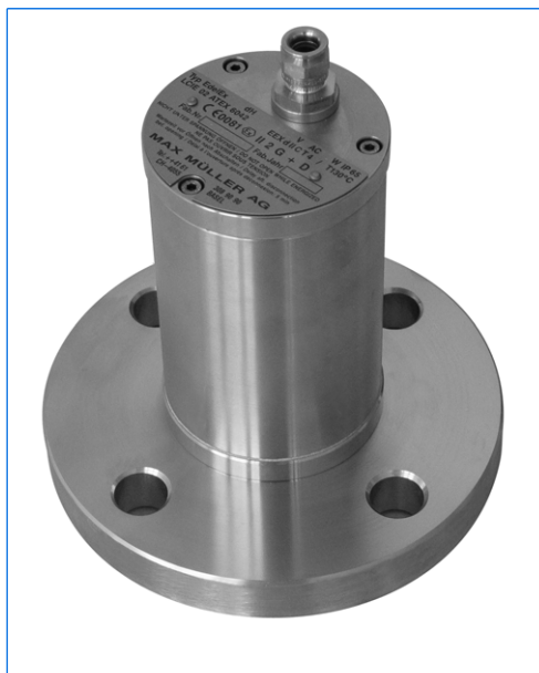
Proiettore tipo EdelEx STERI-LINE 20 dH, 24 V, 20 W, Ex d IIC T4 Gb, Ex t IIIC T130°C Db IP67, Ex II 2 G + D, su flangia con vetro sigillato
